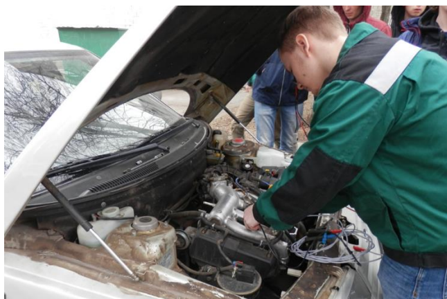
Конкурсант М. Фетисов подключает мотор-тестер для проведения диагностики автомобиля ВАЗ-2112
