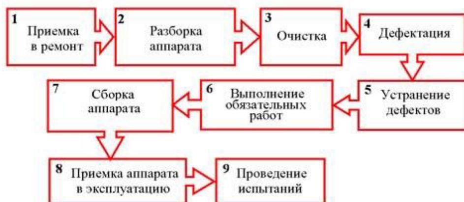
Рис. 1. Схема технологического процесса, соответствующего стратегии ремонта по наработке
